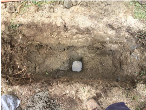
POZO A CIELO ABIERTO PCA-3 PARA MUESTREO ESTRATIGRÁFICO
