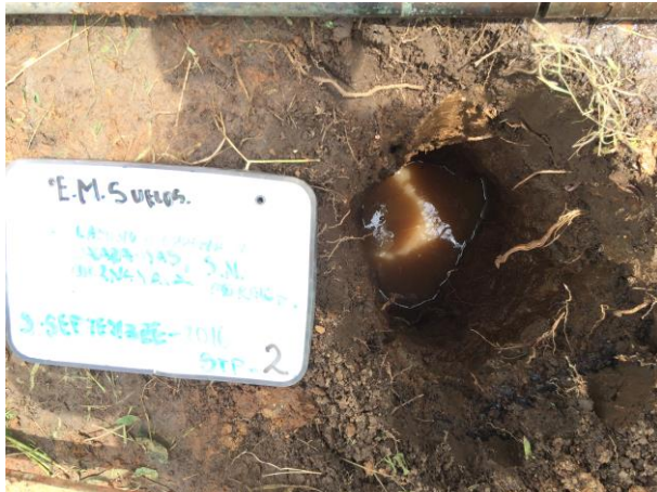
POZO A CIELO ABIERTO PCA-2 PARA MUESTREO ESTRATIGRÁFICO
