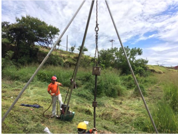
PRUEBA DE PENETRACIÓN ESTÁNDAR SONDEO STP-3
