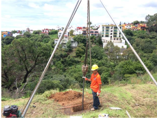
PRUEBA DE PENETRACIÓN ESTÁNDAR SONDEO STP-1
