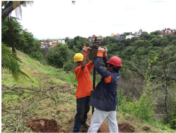
PRUEBA DE PENETRACIÓN ESTÁNDAR SONDEO STP-2
