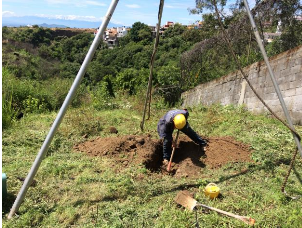
POZO A CIELO ABIERTO PCA-3 PARA MUESTREO ESTRATIGRÁFICO
