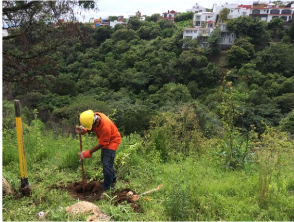
POZO A CIELO ABIERTO PCA-1 PARA MUESTREO ESTRATIGRÁFICO
