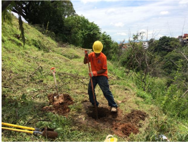
POZO A CIELO ABIERTO PCA-2 PARA MUESTREO ESTRATIGRÁFICO
